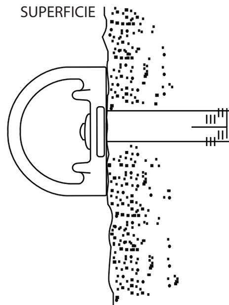
Taladre un orificio del diámetro y profundidad apropiado. La perforación para el perno es 5/8" (16 mm)
