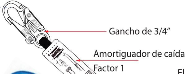
El amortiguador de caída esta diseñado para disipar la energía generada durante una caída y limitar la fuerza de impacto sobre el cuerpo del usuario.
