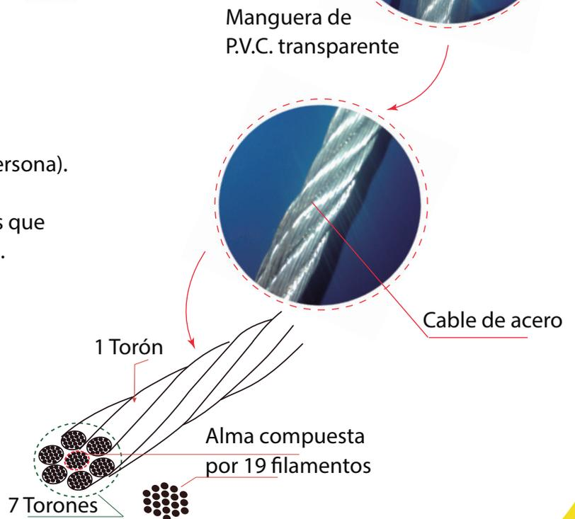
Cable de acero de 1/4", compuesto por 7 torones (6 torones de acero y un alma de acero). En cada torón hay 19 filamentos de cable.
