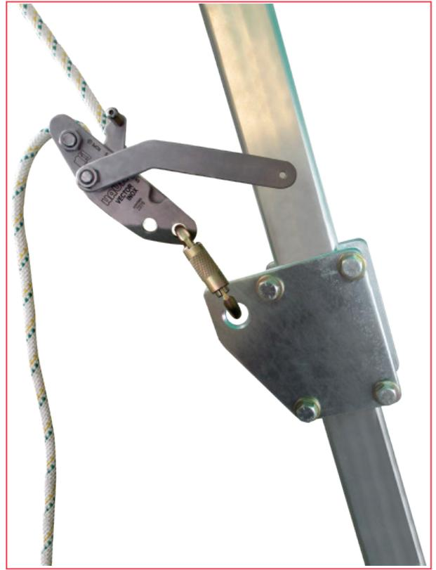
El bloqueador es un aparato mecánico, el cual bloquea cuerdas de diferentes diámetros entre 10.5 y 13 mm
